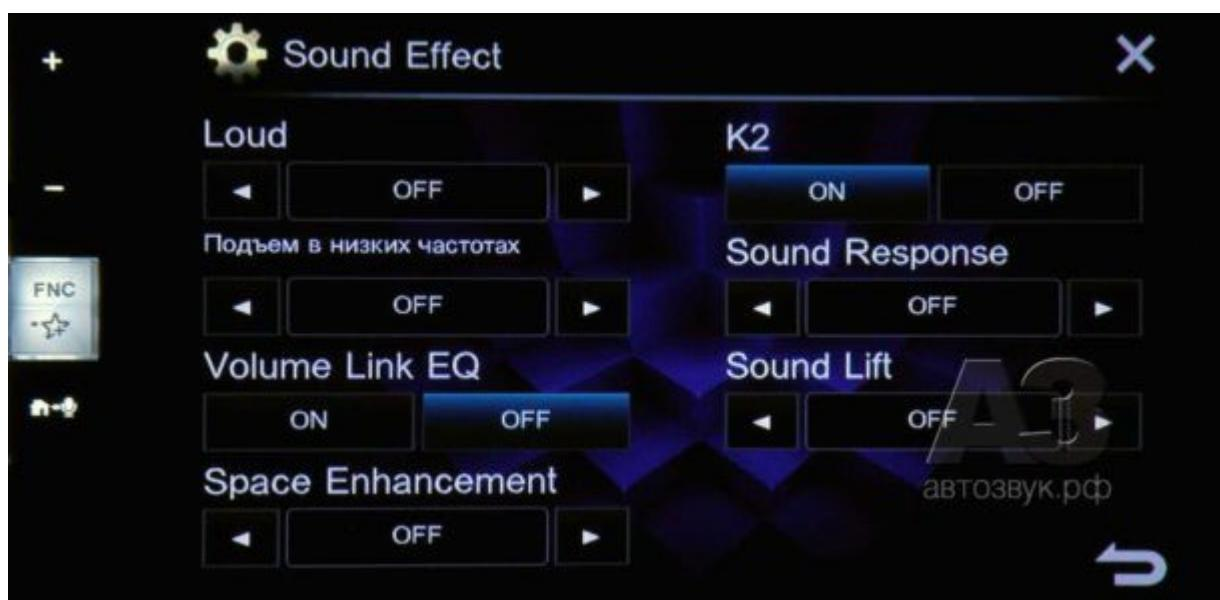
*В раздел «звуковые эффекты» (они в основном обошлись без перевода – это даже к лучшему) помещена и двухуровневая тонкомпенсация, и бас-буст, и пространственные эффекты (Space Enhancement), и «улучшайзеры» компрессированных аудиоформатов (K2 и Sound Response). Подробности – в разделе «Измерения»*
