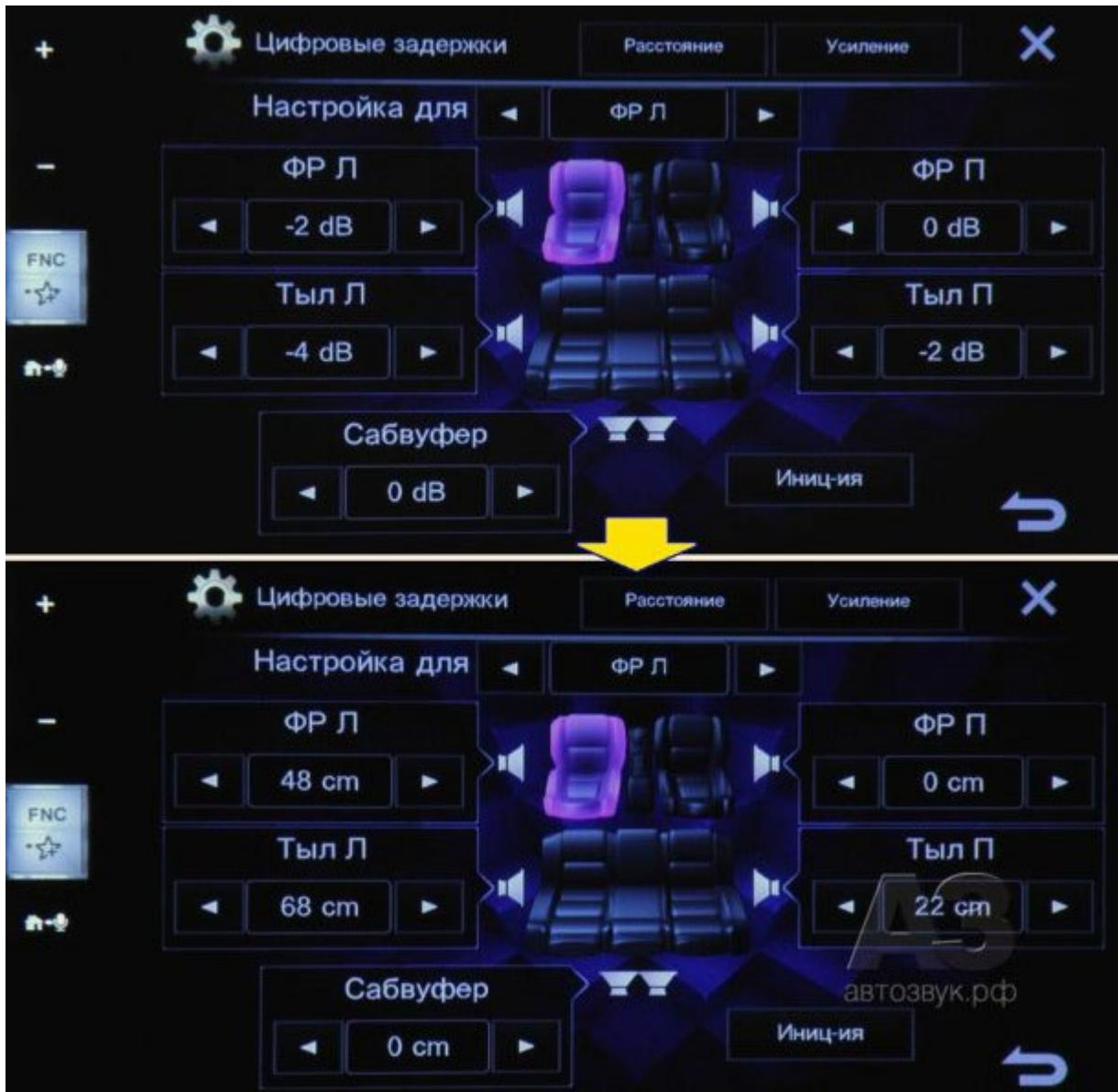
Регулировка временных задержек реализована весьма остроумно и наглядно. Выбираем позицию прослушивания – и, если тип автомобиля и расположение динамиков уже были определены ранее (мы же вас предупреждали!), то все расстояния и уровни сигнала будут установлены автоматически. Если не понравилось – можно не сходя с места подкорректировать «стрелочками». Все регулировки делаются «на лету», специальные процедуры сохранения не требуются
