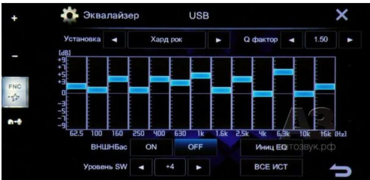
На одном экране собран и графический интерфейс эквалайзера (настраиваемого в режиме «Пользователь»), и его пресеты, а также управление уровнем сабвуфера. Пока не нажата кнопка «ВСЕ ИСТ», настройка эквалайзера остаётся индивидуальной для каждого источника. «Иниц EQ» – сброс настроек в ноль. Предусмотрены 11 предустановок эквалайзера, включая линейную и пользовательскую АЧХ. Подробности – в разделе «Измерения»
