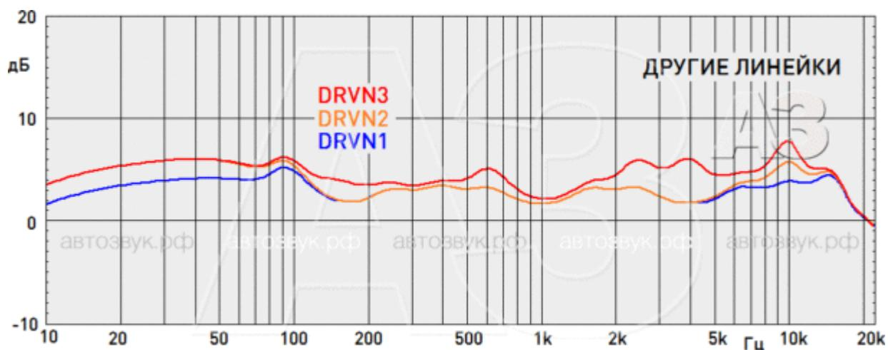
Как говорится, лучше один раз увидеть. Такие кривые были раньше. Новая коррекция на средних и высоких частотах примерно соответствует DRVN2, но кардинальным образом отличается ниже 100 Гц: более заметный подъём в области 60-100 Гц и полное отсутствие коррекции ниже 50 Гц. Это исключает перегрузку встроенных усилителей и акустики даже на уровнях громкости, близких к максимальным
