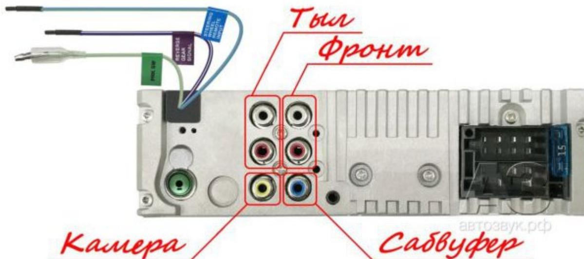
На «кормовой проекции» можно увидеть все отличия. Полный набор линейных выходов 4.1 (сигнал сабвуфера уже просуммирован), вход для камеры заднего обзора, вход для выносного микрофона hands free (входит в комплект). Встроенный разъём ISO, никаких переходников. Три отдельных провода – задний ход для автоматического переключения на камеру, стояночный тормоз (можно сразу на «массу») и вход для кнопок управления на рулевом колесе
