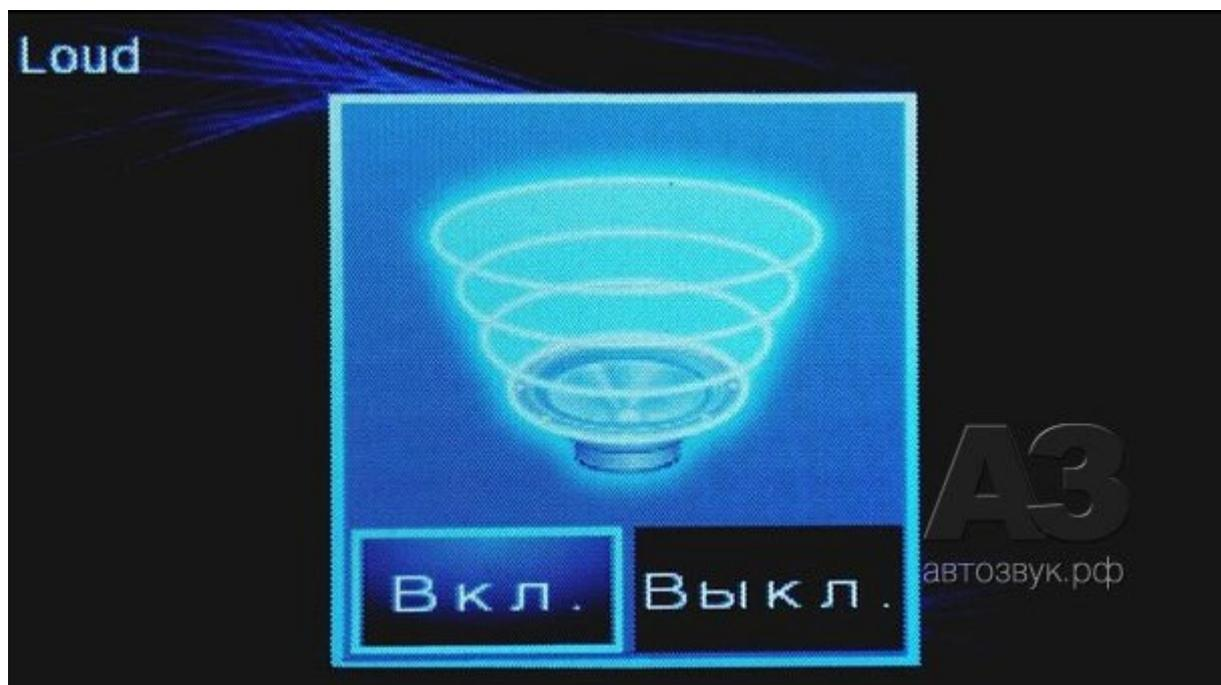
Судя по пиктограмме, этот пункт должен отвечать за включение-выключение сабвуфера. Но всё оказалось не так просто – сигнал на сабвуферном выходе не исчезает, а изменяется характер звучания. Разгадка – в разделе «Измерения»
