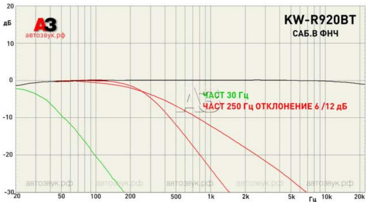
Точно такой же фильтр (в зеркальном отражении) работает на сабвуферном выходе независимо от выбранной конфигурации.
