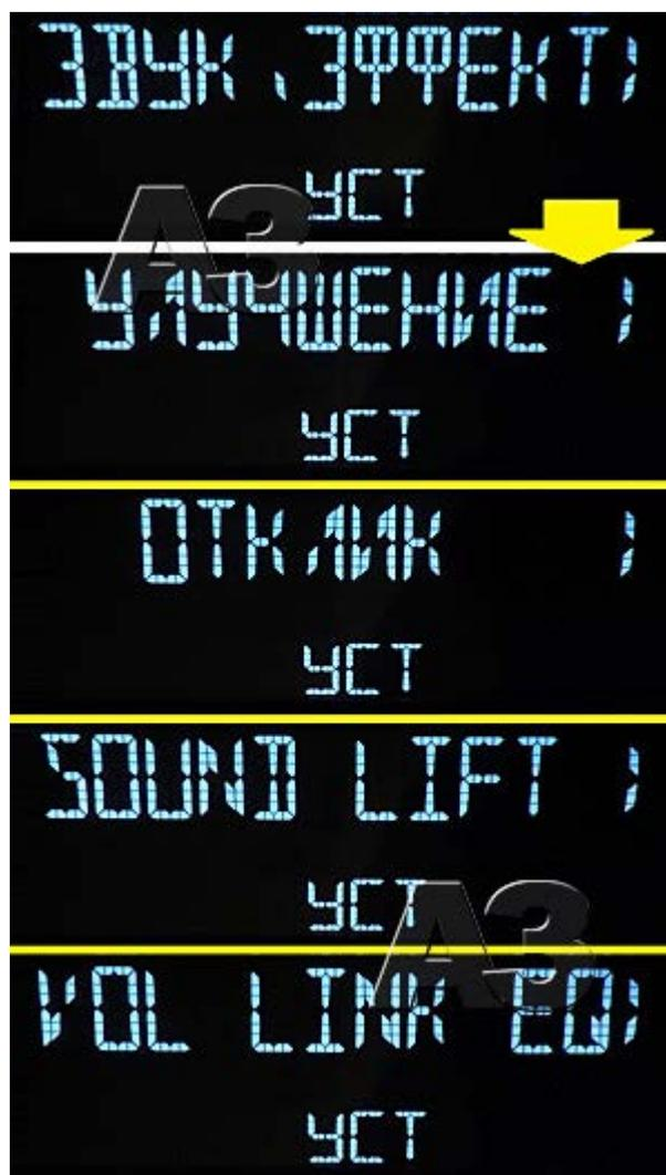
*Есть и набор звуковых эффектов, некоторые из которых вполне можно было включить в общий список настроек. Например, VOL LINK EQ – это дополнительная тонкомпенсация, с другими, нежели у основной, параметрами, SOUND LIFT – коррекция АЧХ на верхних частотах для виртуального подъёма звуковой сцены.*
