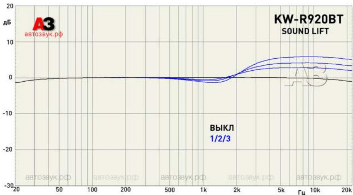
«Подъёмник звука» — корректор кажущейся высоты звуковой сцены — это трёхступенчатый подъём АЧХ выше 2 кГц.
