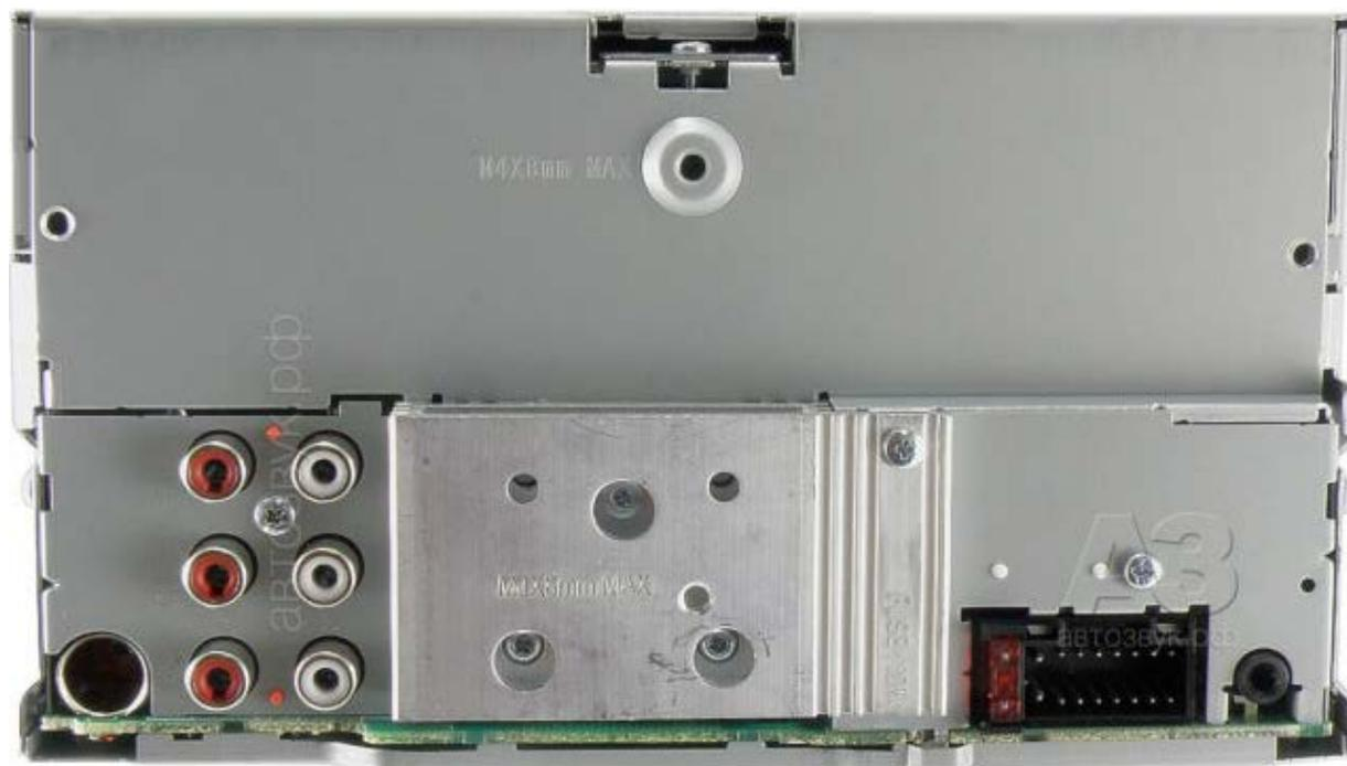
*Панель общения с миром посредством слабых и сильных электрических токов предельно понятна: колодка для токов сильных, полный комплект линейных выходов – для слабых, гнездо микрофона ВТ – для совсем слабых и разъём антенны для микроскопических, но тоже полезных.*
