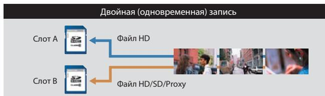
● **Режим резервной записи:** при использовании функции «Rec trigger» для приостановки и повторного запуска записи на одной карте, на вторую карту резервная копия будет записываться полностью без учета приостановки записи на первой карте.\* Этот уникальный режим особенно востребован операторами, которые ведут съемку во время театральных спектаклей или свадеб.
