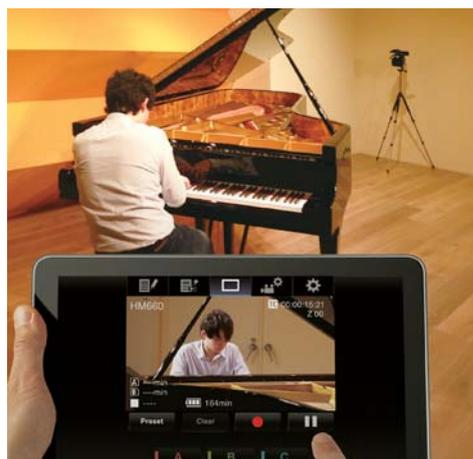
Удаленной от оператора камерой можно управлять со смарт-устройства. Среди доступных функций – запуск/остановка записи, управление зумом, фокусировкой, диафрагмой, а также управление другими настройками одновременно с просмотром текущего изображения на экране смарт-устройства.
