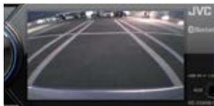
При включении задней передачи на дисплее автоматически проецируется изображение с камеры заднего вида.
