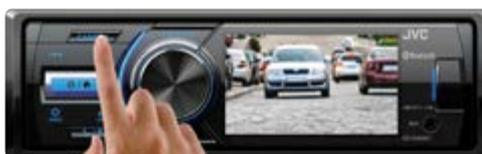
При наличии подключенной камеры заднего вида (приобретается отдельно) в любой момент можно увидеть обстановку позади автомобиля. Для этого нажмите кнопку «КАМЕРА».
